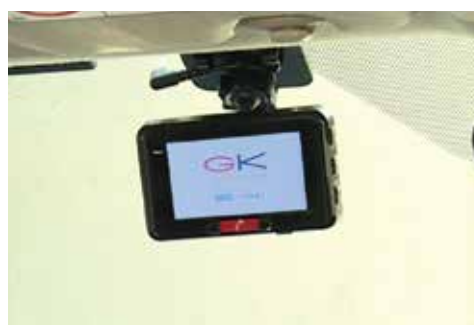
通信機能が付いた専用ドライブレコーダー
